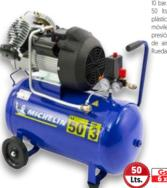
10 bar. 145 l/min. Tanque 50 lts 3HP. Protección para partes móviles Regulador de presión. Salida universal uedas de goma
